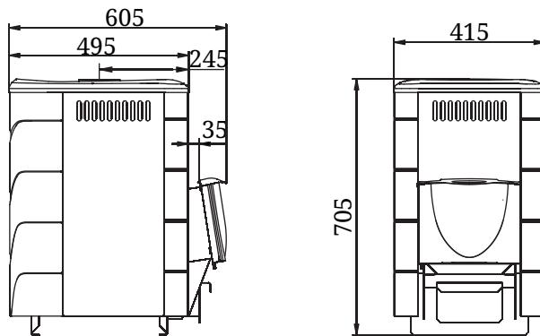
Рисунок 3. Габаритные размеры печи «Компакт 2013» с коротким топливным каналом.
