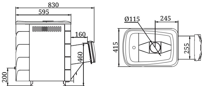
Рисунок 2. Габаритные размеры печи «Компакт 2013 Carbon Б»
