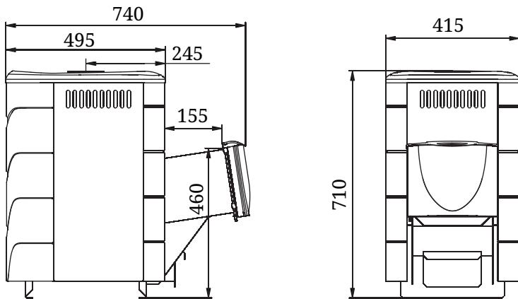
Рисунок 1. Габаритные размеры печи «Компакт 2013 Carbon»
