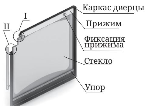
Рисунок 22. Ремонт светорозрачного экрана дверцы модели «Витра»
