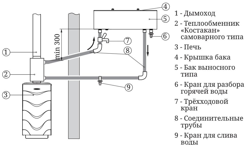
Рисунок 16. Схема монтажа системы водонагрева с использованием теплообменника «самоварного» типа
