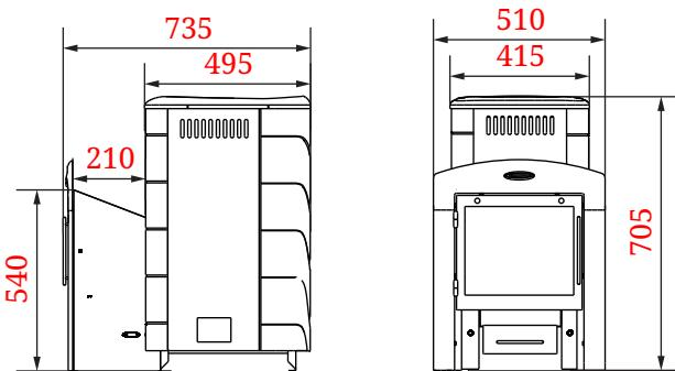
Рисунок 7. Габаритно-монтажные размеры печи «Компакт 2017 Carbon Витра»
